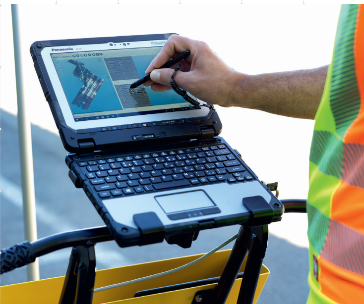
Gerätemonitor mit Graustufenbild, basierend auf Radar-Reflexionen
